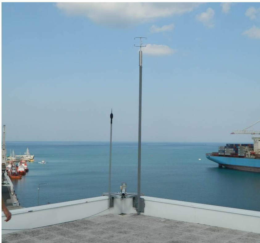
Slika. Sodobna merilna naprava za spremljanje hitrosti in smeri vetra (Ultrasonic Wind Sensor uSonic-3 Omni)
