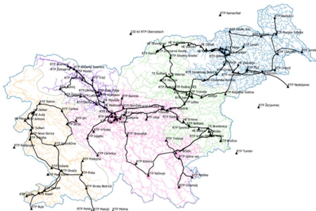
Slika 69: Topologija 110 kV in srednje napetostnih omrežij v Sloveniji
