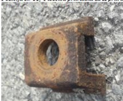
Pozicija št: 11, Ploščica prirčilna za K prirčitev DŽ 8b,
