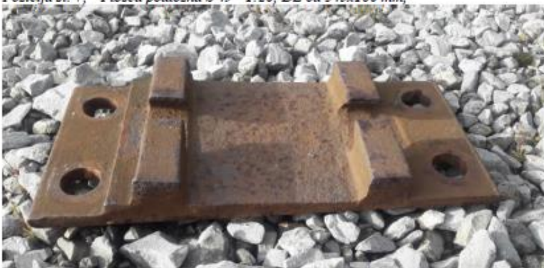
Pozicija št: 8, Plošča podložna S 49 - ravna; DŽ 6a 345x160 mm,
