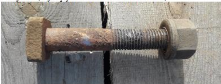
Pozicija št: 13, Vijak T z matico za pritrditev "K" M22x65 - DŽ 11a,
