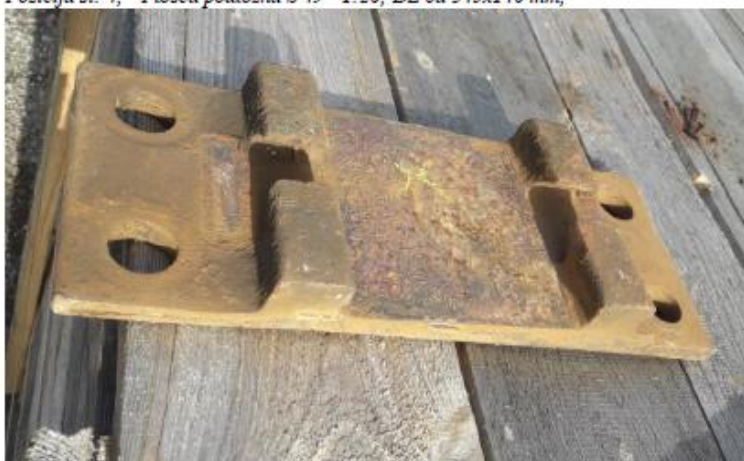
Pozicija št: 5, Plošča podložna S 49 - ravna; DŽ 6a 345x140 mm,
