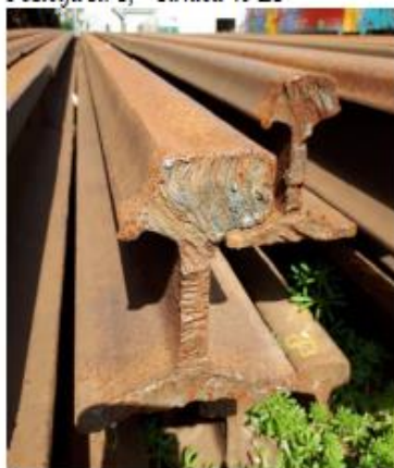
Pozicija št. 2, Tirnica 49 E1 trdnosti 880 Mpa - R260
