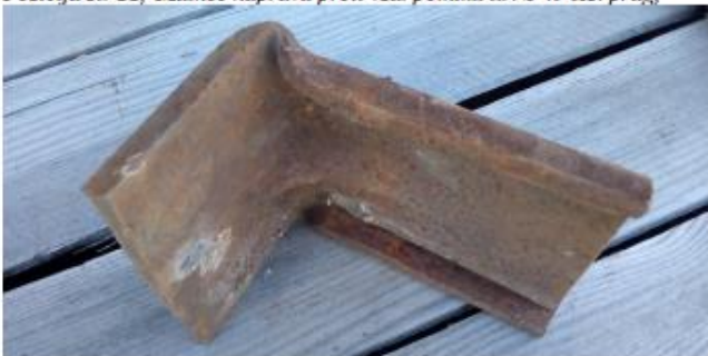
Pozicija št: 22, Mathee naprava proti vzd. pomiku tir. S 49 les. prag,
