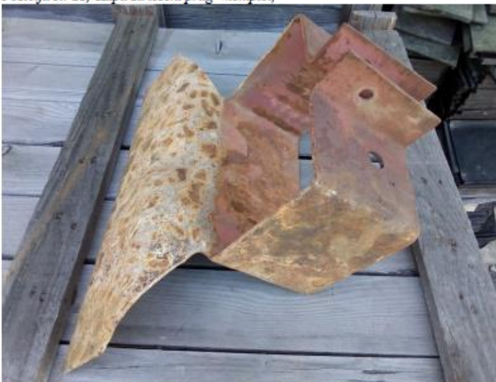
Pozicija št: 22, Mathee naprava proti vzd. pomiku tir. S 49 les. prag,
